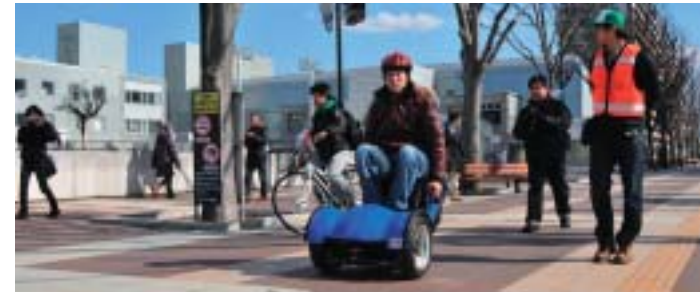
ロボットは、全長1.3メートル、フル充電で4~5時間程度稼働する。最高速度は時速6キロ
